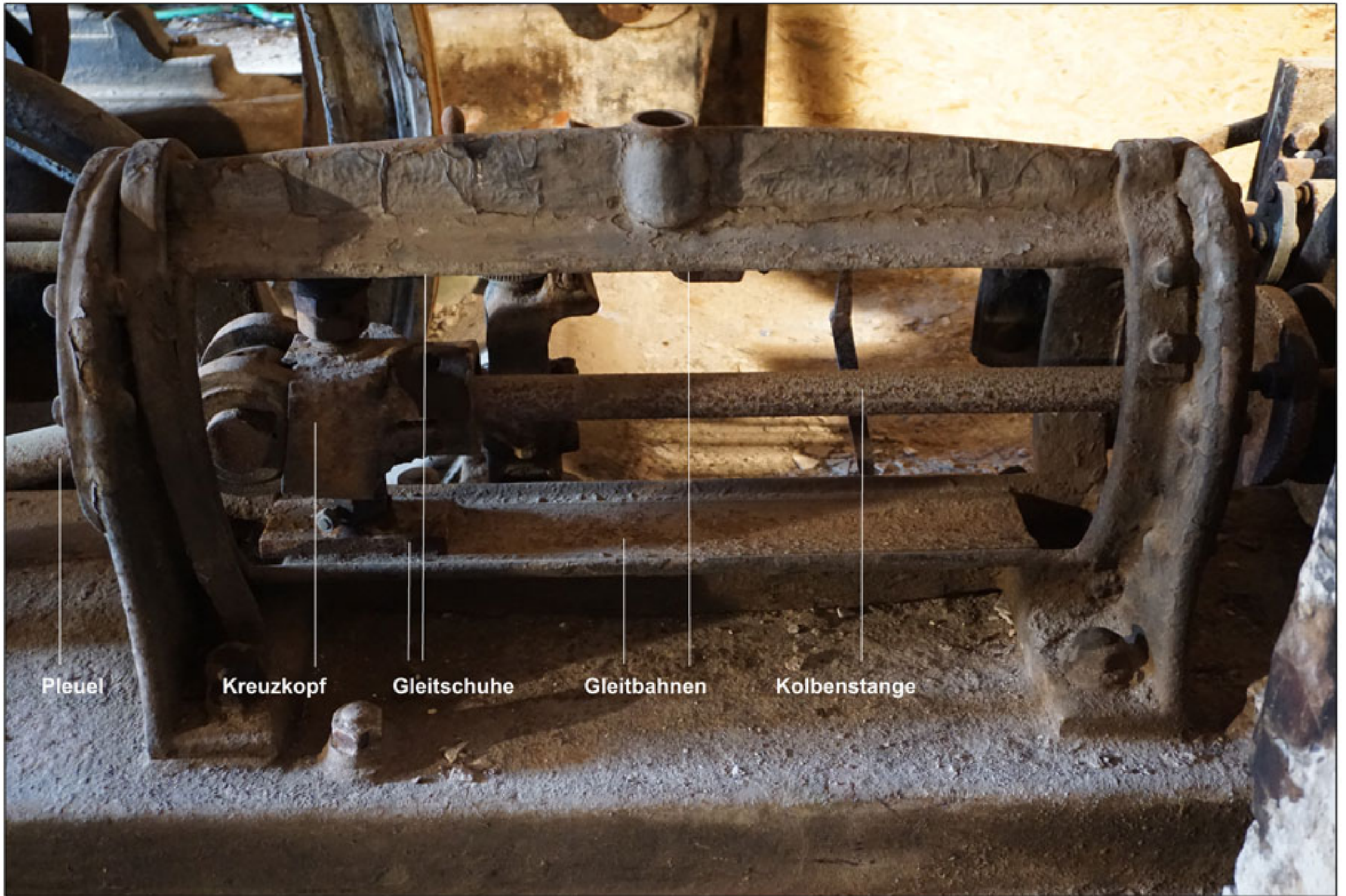
Dampfmaschine „Wegelin & Hübner Halle / Saale“ der Brennerei im eh. Rittergut, um 1875 16259 Falkenberg, Cöthen 66 / 67
